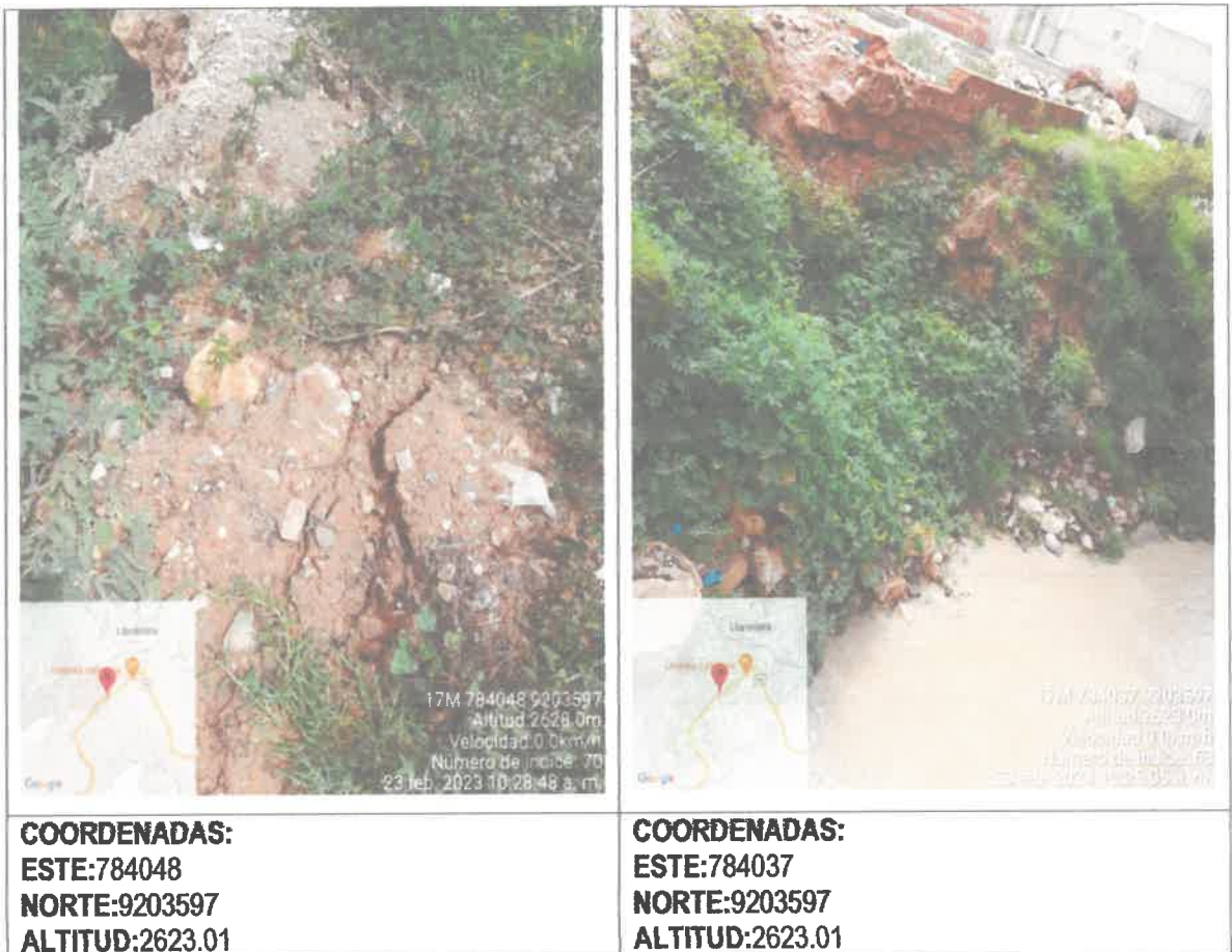
Figura 16: Fuertes precipitaciones generan fisuras en el suelo, produciendo deslizamiento e inestabilidad del suelo en las viviendas aledañas.
